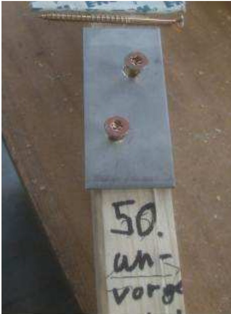
Picture 7 6.0x90 Din 571 spax screw
